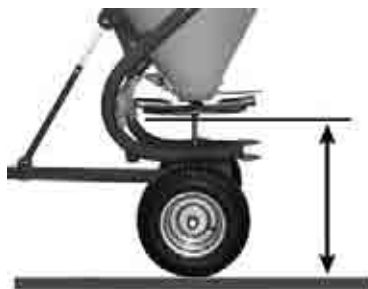
Posición correcta del disco esparcidor
